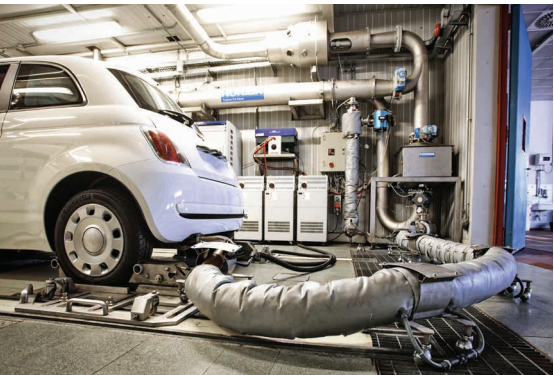
자동차 배기가스 검사장. 보통 자동차에는 배기가스에서 질소산화물이나 일산화탄소를 없애는 촉매변환장치가 달려 있다. © shutterstock.com
