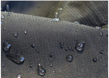
아웃도어 제품에 많이 쓰이는 고어텍스 소재는 빗방울이 침투하지 못하게 하는 동시에 땀은 수증기 형태로 방출하도록 해준다. © shutterstock.com
